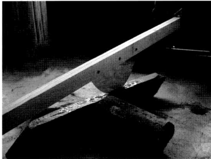
Abb. 12 Für die Versuche gebaute Rückensäge mit einem halbkreisförmigen Blatt aus Bronzeblech
