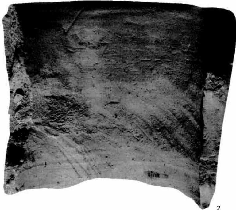
Tonrohr mit aufgemaltem Dreiecksymbol (1) und Herstellungsspuren auf der Rohrinnenseite im Übergangsbereich vom Schaft zur breiten Mündung (2) (beide unmaßstäblich).
