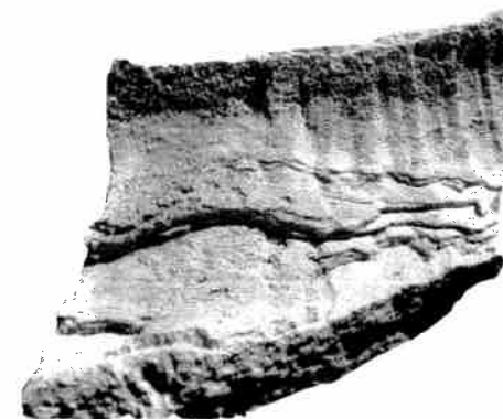
Abb. 85: Rohrfragment mit Kalksinterschichten.
