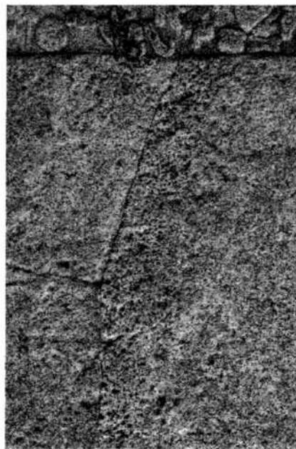
Fig. 25. Fissure le long d'une zone vésiculaire et seconde fissure perpendiculaire à cette zone.
