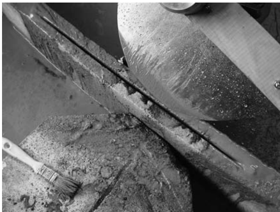
Abb. 7 Beim Sägen muss immer wieder Schleifpulver (hier Schmirgel) und Wasser hinzugegeben werden. Der Schnitt wurde in einer dünnen Kalksteinplatte erzeugt
