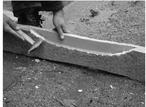
Abb. 8 Mit einem Hammer wurde die eine Seite der Wandung neben dem konkav in den Stein eingedrunghenen Sägeschnitt weggeschlagen
