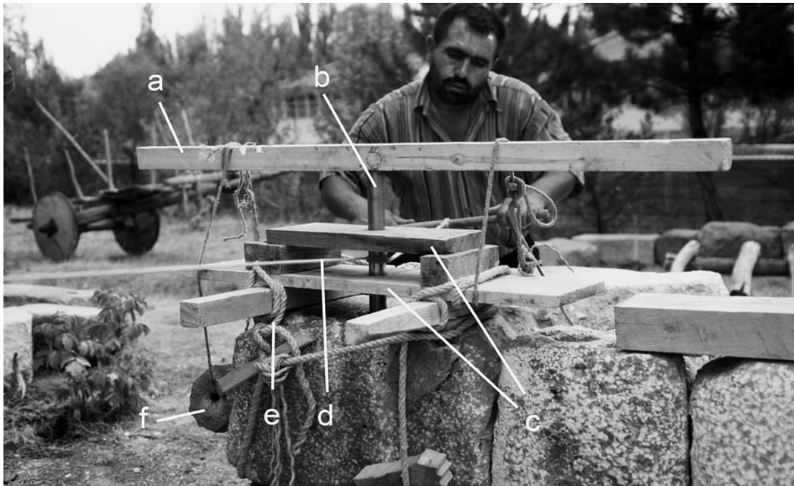
Abb. 1 Einfache Bohrmaschine zur Erzeugung von Hohlbohrungen: Ein Metallrohr wird in eine rahmenartige Führung aus Holz gesetzt und durch abwechselndes beidseitiges Ziehen an einer darumgewickelten Schnur in rotierende Bewegung versetzt – a. Gewichtsbalken. – b. Bohrrohr aus Metallblech. – c. Führungsbretter des Holzrahmens für das Bohrrohr. – d. Antriebsseil, wird von zwei Personen hin- und hergezogen. – e. Befestigung des Rahmengestells mit Seilen, um ein seitliches Verrutschen zu Verhindern. – f. Gewicht (hängt am Gewichtsbalken a)
